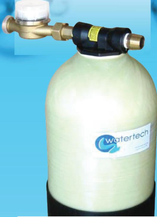
Y 10 هو جهاز منقي لتبادل أيوني محمول و لتنتاج المياه العذبة ومملء تركيبات التدفئة وفقا للمعيار. VDI 2035 فمن خلل تنقية الماء، سيتم تقليل تكوين الحجر الجيري في المبدلت إلى حد كبير. ويقدم BABY 10 على شكل منقي محمول من البوليثيلين ، مثبت فوق عداد، لقياس السعة المستعملة.
